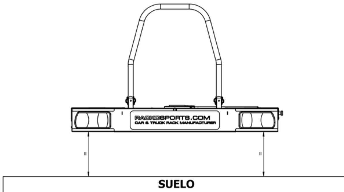
Colocar la plataforma en la bola del coche y comprobar que la altura de las luces en las misma.
